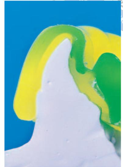
Abb. 8 Schnitt durch den Inzisalbereich eines Multilayer-Zahnschutzes: Man beachte die ungenügende Schichtstärke der ersten Folie, was einer einfachen Laminierung entspräche.
