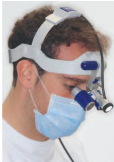
Abb. 4 Prismenlupenbrille (Kepler'sches System; 4,3fache Vergrößerung) mit Xenon-Beleuchtung.
