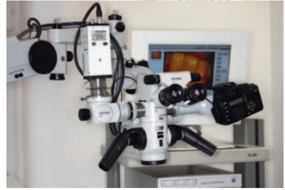
Abb. 6 Operationsmikroskop mit Ausstattung zur Dokumentation mittels digitalem Fotoapparat sowie mit digitaler Videokamera und Schnittleinheit.
