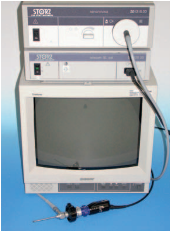
Abb. 12 Endoskopieeinheit, bestehend aus Endoskop mit Kamerakopf, Lichtquelle, Videokamera und Monitor (ab ca. 6.000,- € für eine Standard-Analoglösung; auch digitale und HDTV-Konfiguration möglich).
