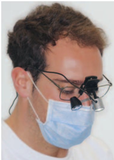
Abb. 3 Einfache Lupenbrille (Galilei'sches System) mit LED-Beleuchtung.
