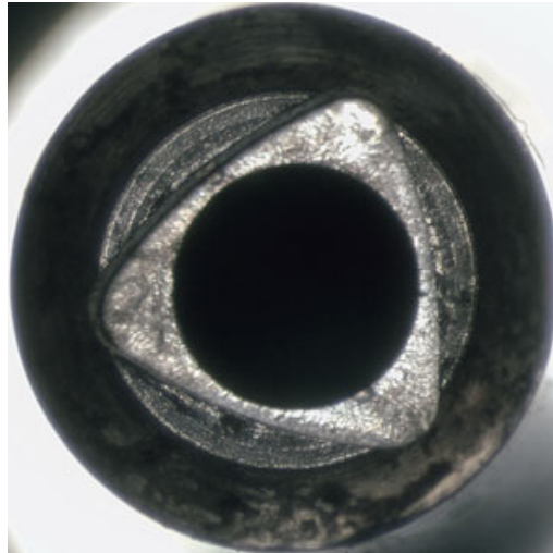
Abb. 5 Dreiecksform des Ausdrehwerkzeugs (Blick von unten)
