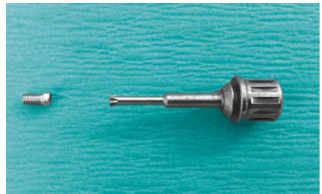
Abb. 2 Langer Schraubendreher mit der Minischraube zur Fixation des Ausdrehwerkzeugs
