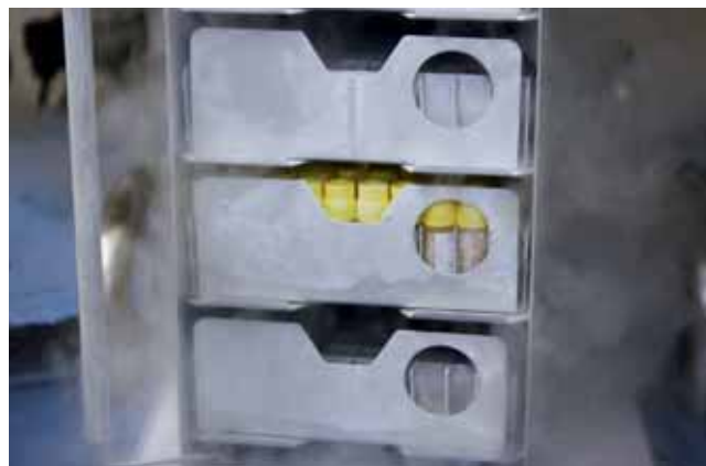
Abb. 8 Die Container werden in Kassetten geordnet in die mit flüssigem Stickstoff gefüllten Tanks gestellt.
