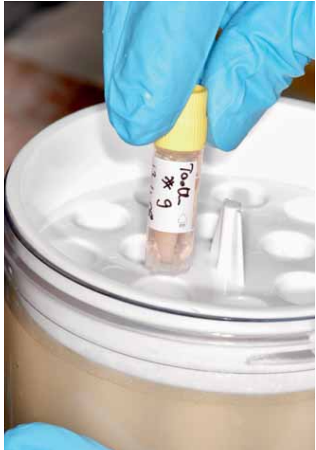
Abb. 7 Lagerung des Containers in einem mit Isopropanol gefüllten Behälter.
